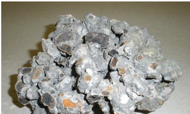
59. Agloporītbetons (drumstala, no lielajām agloporīta granulām). Ražots Daugavpils būvmateriālu un konstrukciju rūpnīcā Kalkūnos 20. gs. 60. gados. Atrada Oļegs Papsujevičs bijušās Daugavpils būvmateriālu un konstrukciju rūpnīcas teritorijā Kalkūnos 22.03.2009.
