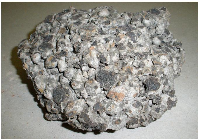
58. Agloporītbetons (drumstala, no mazajām agloporīta granulām). Ražots Daugavpils būvmateriālu un konstrukciju rūpnīcā Kalkūnos 20. gs. 60. gados. Atrada Oļegs Papsujevičs bijušās Daugavpils būvmateriālu un konstrukciju rūpnīcas teritorijā Kalkūnos 22.03.2009.
